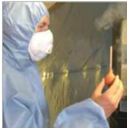
[그림 7-8] 발연관을 이용한 밀폐 적정유무 확인방법
