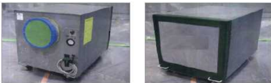
[그림 4-7] 음압기의 배기구(좌) 및 흡입구(우)의 밀봉 예
