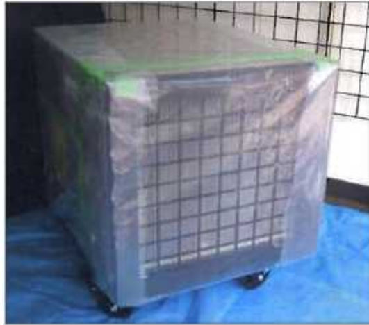
[그림 4-8] 이동 및 보관시 음압기 밀봉 예
