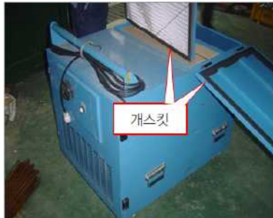
[그림 4-3] 공기누설 방지를 위한 개스킷 설치 예
